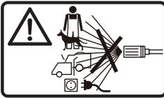
**WARNUNG:** Der Wasserstrahl darf niemals auf Personen, Tiere, elektrische Geräte oder auf das Hochdruckgerät selbst gerichtet werden.
