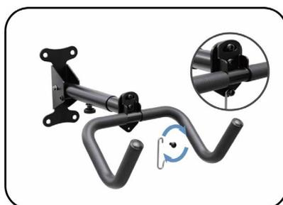
4. Der Haken wird mit einer Schraube in der untersten Position befestigt.
