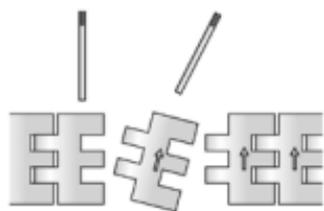
Entfernen Sie in gleicher Weise den zweiten Verbundstift. Nehmen Sie nun das lose Metallbandglied heraus. Wenn nötig, können weitere Metallbandglieder auf dieselbe Weise entfernt werden.
