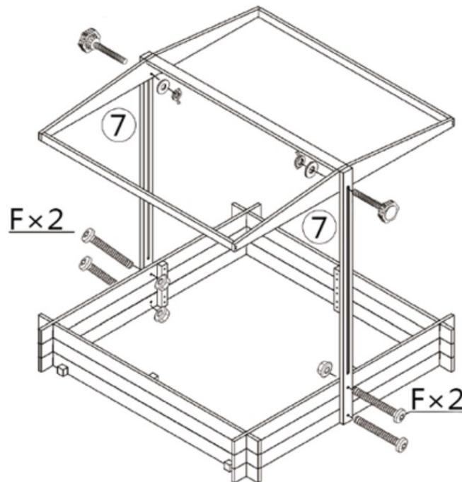
Schritt 7: Fixieren Sie das Dachgestell mit den 4 Schrauben (G) und den Befestigungen (14). Die Befestigungen sollten den Pfosten rechts und links eingrenzen, sodass das Dach nicht verrutscht.
