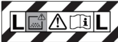
Dieser Nass-Trockensauger entspricht der Staubklasse „L“ und ist nach EN 60335-2-69 Richtlinie des Trockensaugers für den Einsatz bei Hausstaub, Sand, Gips, Kalk etc. geeignet. Betreiben Sie den Sauger niemals ohne die Filtervorrichtungen.
