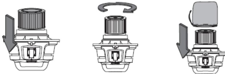
**⚠ ACHTUNG** Der HEPA-Filter und der Staubsaugerbeutel werden nur für das Trockensaugen verwendet. Falls Sie Nasssaugen wollen, müssen der Staubsaugerbeutel und HEPA-Filter ausgebaut und durch den Schaumstofffilter ersetzt werden.
