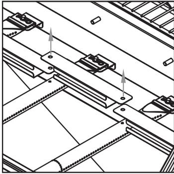
2. Splint lösen und Brenneroehr entnehmen.
