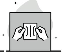
Für eine genaue Ausrichtung des Artikels setzen Sie bitte erst die Artikel Unterkante (bei runden Klebestreifen) oder die längliche Kante (bei eckigen Klebestreifen) schräg auf der Oberfläche an und drücken dann die restliche Klebefläche gleichmäßig an.
