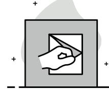
Ziehen Sie die Schutzfolie des 3M-Klebers am Produkt ab, ohne die Klebefläche selbst zu berühren.
