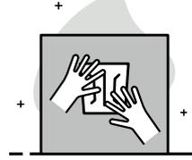
Drücken Sie das Produkt für ca. 60 Sekunden fest auf den Untergrund. Bitte achten Sie darauf, die gesamte Klebefläche fest anzudrücken, damit sich die maximale Klebekraft großflächig entfaltet.
