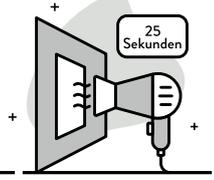
Optional können Sie die zu beklebende Stelle für ca. 25 Sekunden mit einem Haartrockner mit einem Abstand von 15 cm erhitzen. Zusätzlich kann man die Klebefläche des Badaccessoires für 15 Sek. mit dem Haartrockner erhitzen. Dies verbessert die Soforthaftung.
