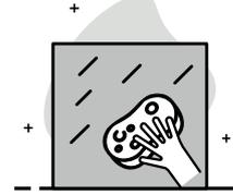
Die zu beklebende Fläche muss tragfähig, sauber, trocken, fett- und trennmittelfrei sein. Reinigen Sie die Oberfläche bitte gründlich, im Idealfall mit Ethanol oder Reinigungsalkohol. Bitte keinen Badreiniger verwenden.
