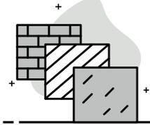
Bitte bringen Sie den Badartikel mit dem 3M-Klebestreifen nur auf einem geeigneten und ebenen Untergrund und nicht auf Fugen an. Mögliche Untergründe sind Fliesen, Marmor, Glas, Metalle oder Verbundstoffe. Der Artikel kann nicht auf verputzten Untergründen angebracht werden.
