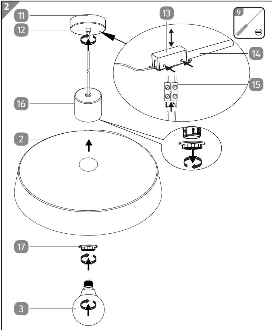
1. Öffnen Sie die Klemmenbox **13** mithilfe eines Schlitzschraubendrehers 3 mm **9**.
