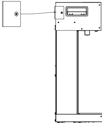
**2.1B** Επιλέξτε έναν σταθερό τοίχο και τοποθετήστε την δοκό συναρμολόγησης στην επιθυμητή θέση ανάρτησης του ηλεκτρικού τζακιού. Σημειώστε αφού ευθυγραμμίσετε τη βάση στερέωσης τα σημεία των 5 οπών διάτρησης στον τοίχο. Ανοίξτε τις 5 τρύπες για το μέγεθος βύσματος ούπατ που πρόκειται να χρησιμοποιήσετε για την τοποθέτηση.
