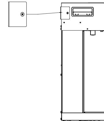
**2.1B** Elija una pared estable y monte el listón de montaje en la posición en la que desea colgar la chimenea eléctrica. Después de alinear el soporte, marque los 5 orificios en la pared. Taladre los 5 orificios para el tamaño de taca adecuado que desee utilizar para el montaje.
