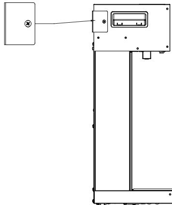
**2.1B** Choisissez un mur stable et montez la barre de montage à l'endroit où vous voulez suspendre la cheminée électrique. Marquage. Après avoir aligné les supports, percez 5 trous dans le mur. Percez les 5 trous pour la taille de cheville appropriée que vous voulez utiliser pour le montage.
