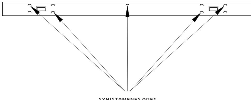
**2.1C** Εισαγάγετε τα βύσματα ούπατ στις 5 οπές διάτρησης. Μετά στερεώστε τη δοκό συναρμολόγησης με 5 βίδες ST5 x 40 στον τοίχο.
