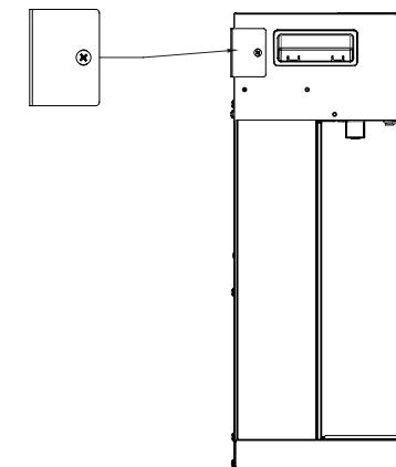
**2.1B** Entscheiden Sie sich für eine stabile Wand und montieren Sie die Montageleiste in der Position, in der Sie den Elektrokamin aufhängen möchten. Markieren Sie nach dem Ausrichten der Halterung, die 5 Bohrlöcher an der Wand. Bohren Sie die 5 Bohrlöcher für die passenden Dübelgröße, welche Sie zur Montage verwenden möchten.
