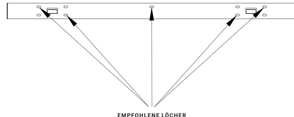
**2.1C** Drücken Sie die Kunststoffdübel in die 5 Bohrlöcher. Dann fixieren Sie die Montageleiste mit 5 Schrauben ST5 x 40 an der Wand.
