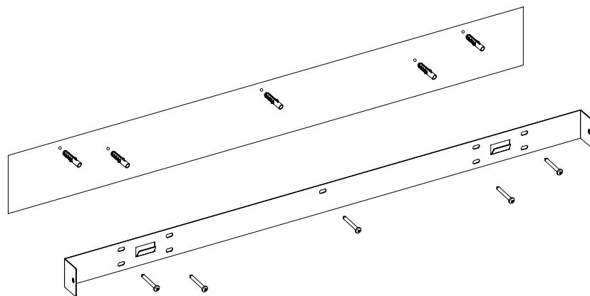
**2.1D** Za pomocą czterech śrub ST4 x 8 przyjmocuj wsporniki o kształcie L do podstawy kominka. Zawieś kominek na zamocowaniu i zaznacz na ścianie dwa miejsca na otwory dla wsporników w kształcie L. Następnie zdejmij kominek. Wywierć dwa otwory wiertłem o grubości 8 mm w zaznaczonych miejscach. Na końcu użyj plastikowych kołków. Za pomocą dwóch śrub ST4 x 8 przyjmocuj kominek do zamocowania. Za pomocą dwóch śrub ST5 x 40 przyjmocuj wsporniki o kształcie L do ściany.
