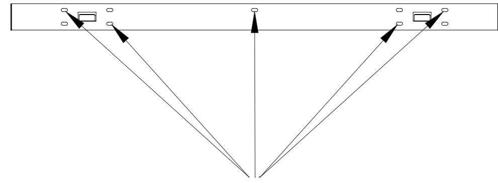
**2.1C** Inserte los tacos de plástico en los 5 orificios. Después, fije el listón de montaje a la pared con 5 tornillos ST5 x 40.
