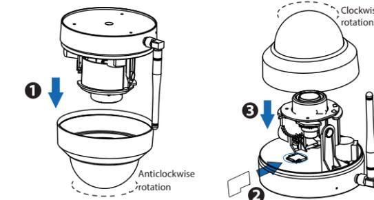
3. Befestigen Sie die Abdeckung, indem Sie sie im Uhrzeigersinn drehen. Wenn Sie keine SD Karte zum speichern verwenden möchten, können Sie sich dafür entscheiden, die SD-Karte nicht zu installieren (in diesem Fall können die Schritte 1-3 ignoriert werden, und Sie können mit der Installation mit Schritt 4 beginnen).
