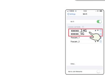
**Tipp:** Die Kamera unterstützt Dual-Band 2,4 GHz & 5 GHz WiFi, sodass Sie den Kanal Tipps: mit dem stärkeren Signal wählen können. Wählen Sie beispielsweise SSID: XXXXX\_2.4G oder XXXXX\_5G.
