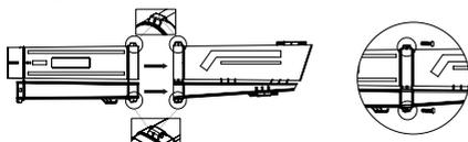
2. Setzen Sie den oberen Kanal in das Gerät ein und schrauben Sie ihn fest.
