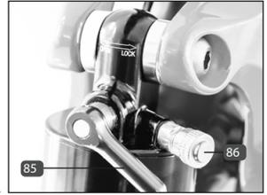
Wird der SAG-Wert über- bzw. unterschritten, so muss der Luftdruck des Dämpfers angepasst werden.
