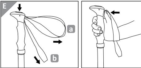
1. Drücken Sie den Knopf auf dem Griff ein, so dass die Verstellvorrichtung sichtbar wird.
