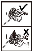
Dieses Symbol weist darauf hin, dass die Kurbel der Schlauchtrommel zum Aufwickeln des Hochdruckschlauchs nur entgegen dem Uhrzeigersinn gedreht werden darf. Das Aufwickeln in entgegengesetzte Richtung kann den Hochdruckschlauch und den Reiniger beschädigen.
