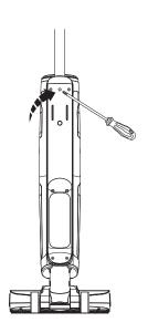
Um den Griff zu montieren, setzen Sie ihn in das Gerät ein, bis er hörbar einrastet. Falls der Griff gelöst werden muss, drücken Sie die Feder mit einem Werkzeug (z.B. einem Schraubendreher) und nehmen Sie den gelösten Griff vom Gerät ab.
