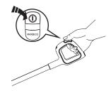
Drücken Sie die Taste ① , um das Gerät standardmäßig im ECO-Modus zu starten. Drücken Sie die Taste erneut, um das Gerät auszuschalten. Wechseln Sie durch Drücken der MaxIECO)-Taste zwischen ECO- und MAX-Modus.
