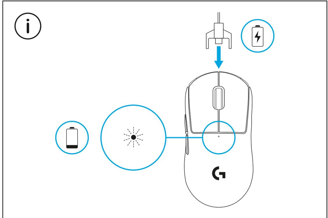
Für eine optimale kabellose Leistung sollten Sie die Maus aus höchstens 20 cm Entfernung vom Empfänger und mehr als 2 m entfernt von 2,4 GHz-Interferenzquellen (wie z. B. WLAN-Router) verwenden.
